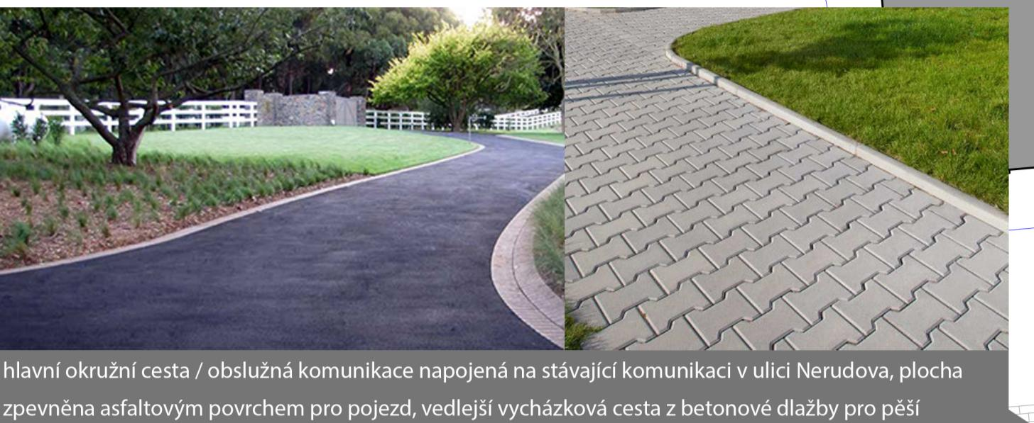
hlavní okružní cesta / obslužná komunikace napojená na stávající komunikaci v ulici Nerudova, plocha zpevněna asfaltovým povrchem pro pojízd, vedlejší vycházková cesta z betonové dlažby pro pěší
